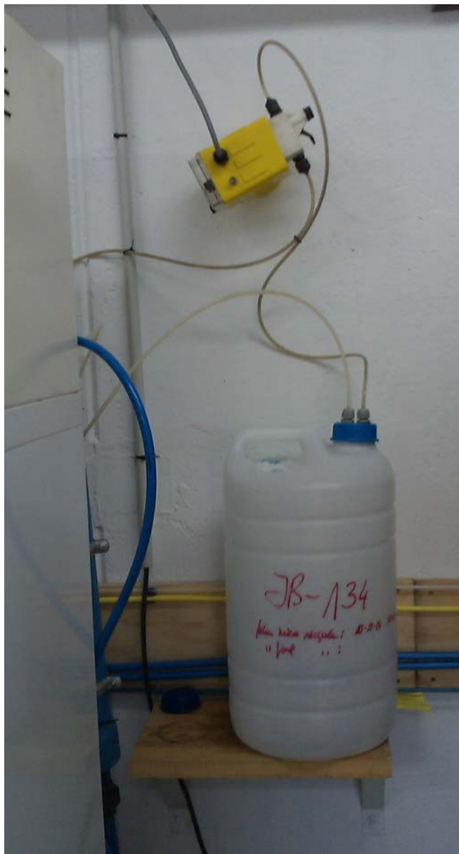
Sistema para la recogida de muestra en continuo, instalado en la estación de Jabarrella.
