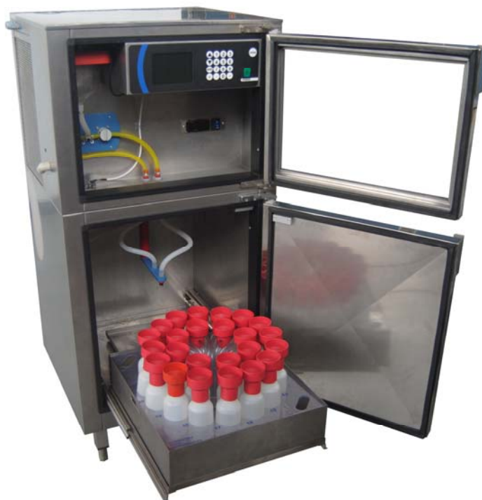
Equipo tomamuestras M104, instalado en las estación de Ascó y Xerta.
