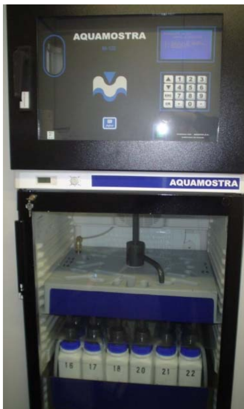
Equipo AquaMostra: Tomamuestras automático refrigerado
