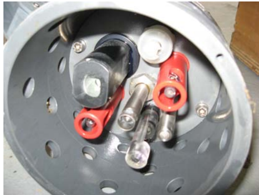
Vista de las sondas integradas en el equipo Aquasonda
