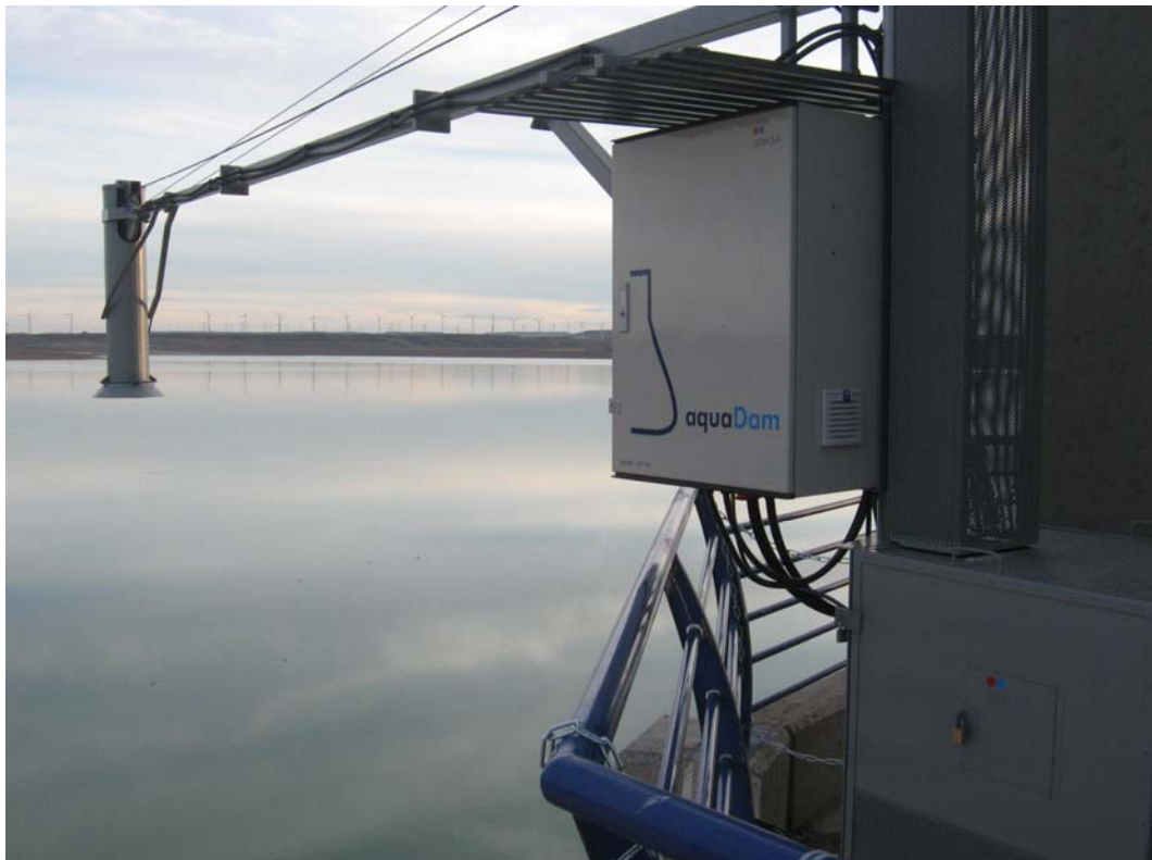
Sonda instalada en el embalse de La Loteta
