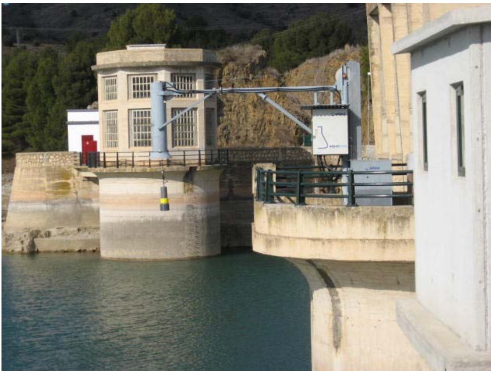
Sonda instalada en el embalse de La Tranquera
