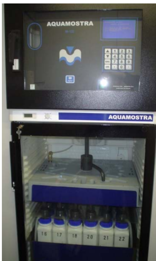
Equipo AquaMostra: Tomamuestras automático refrigerado
